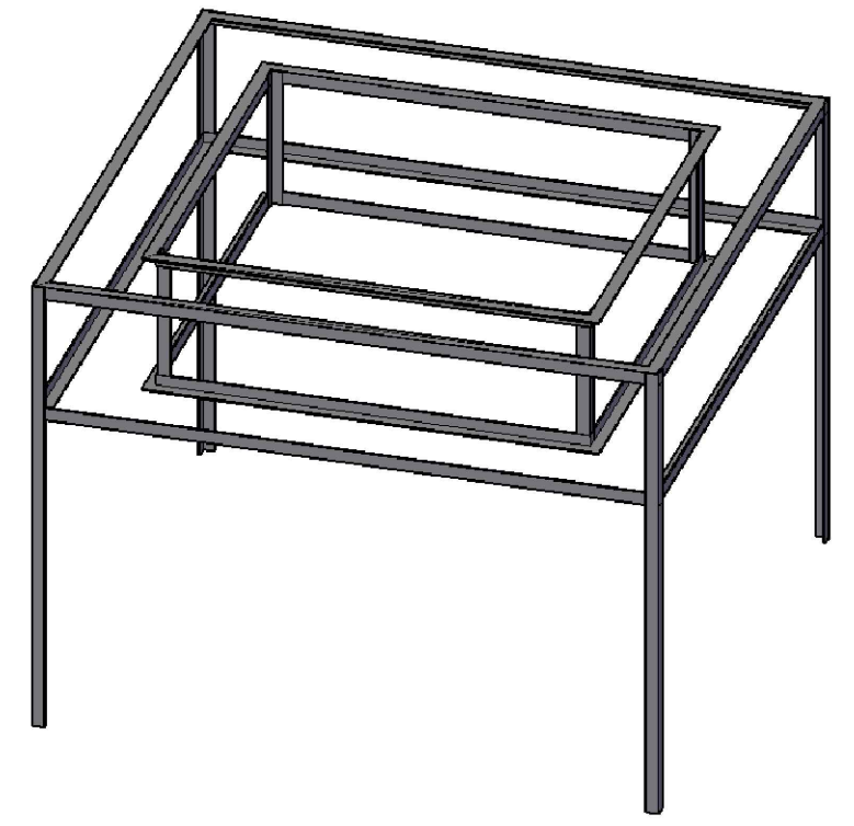
Обвязка блоков ФБС уголком 50х50х5
